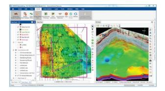
Visualización integrada de resultados en tiempo real: Geomodele mientras interpreta en secciones transversales sincronizadas con el diagrama de cerca en 3D y vista de mapa.
